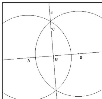
FIG. 3 – Tracé d'un triangle rectangle ABC à la règle et au compas
